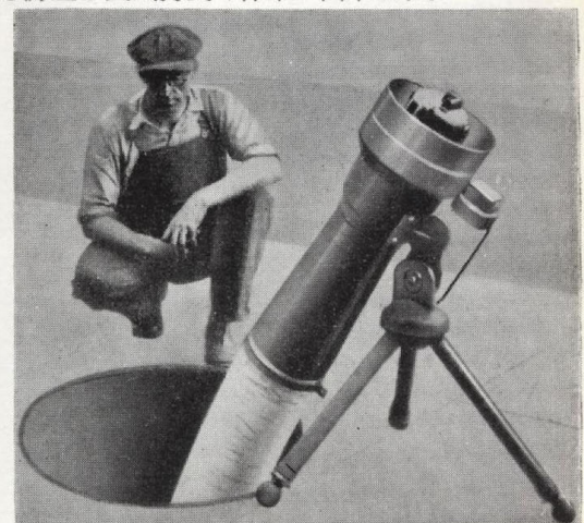
マンホール用 作業に先立ち排気管を突込んでファンを回転すれば入坑しても安全です。この方法をとらずに作業することは危険です。
