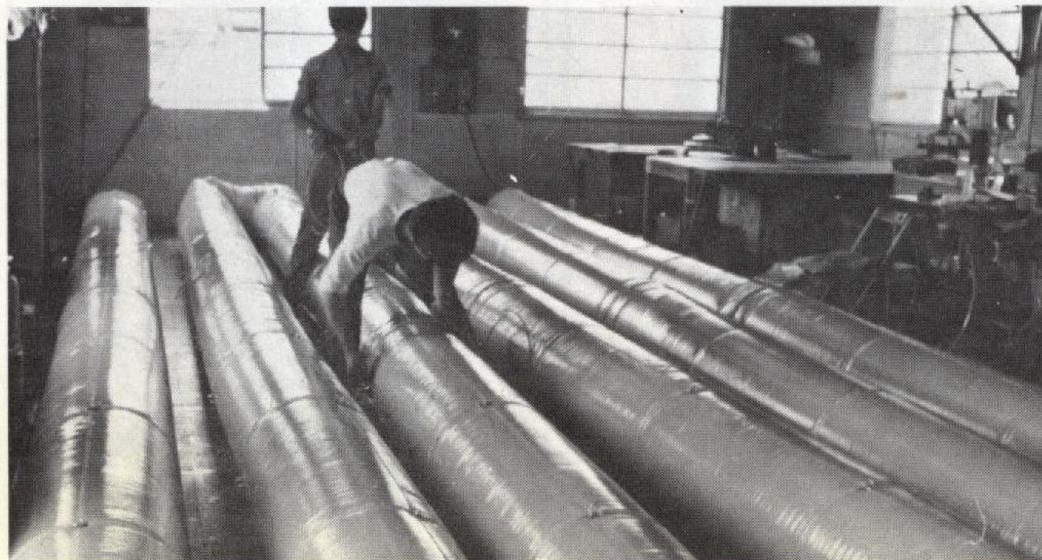
送风管の製品検査状況
