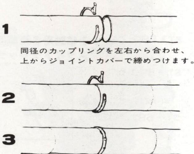
絶対にはずれず、管内の圧が高いほど漏風率が下がります。
