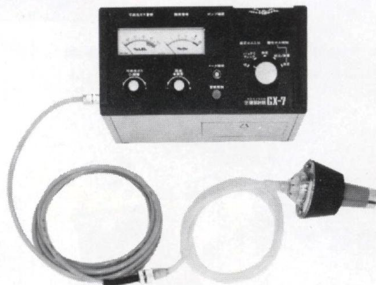
GX-7(CO・O 2 ・CH 4 ) (理研計器製)
