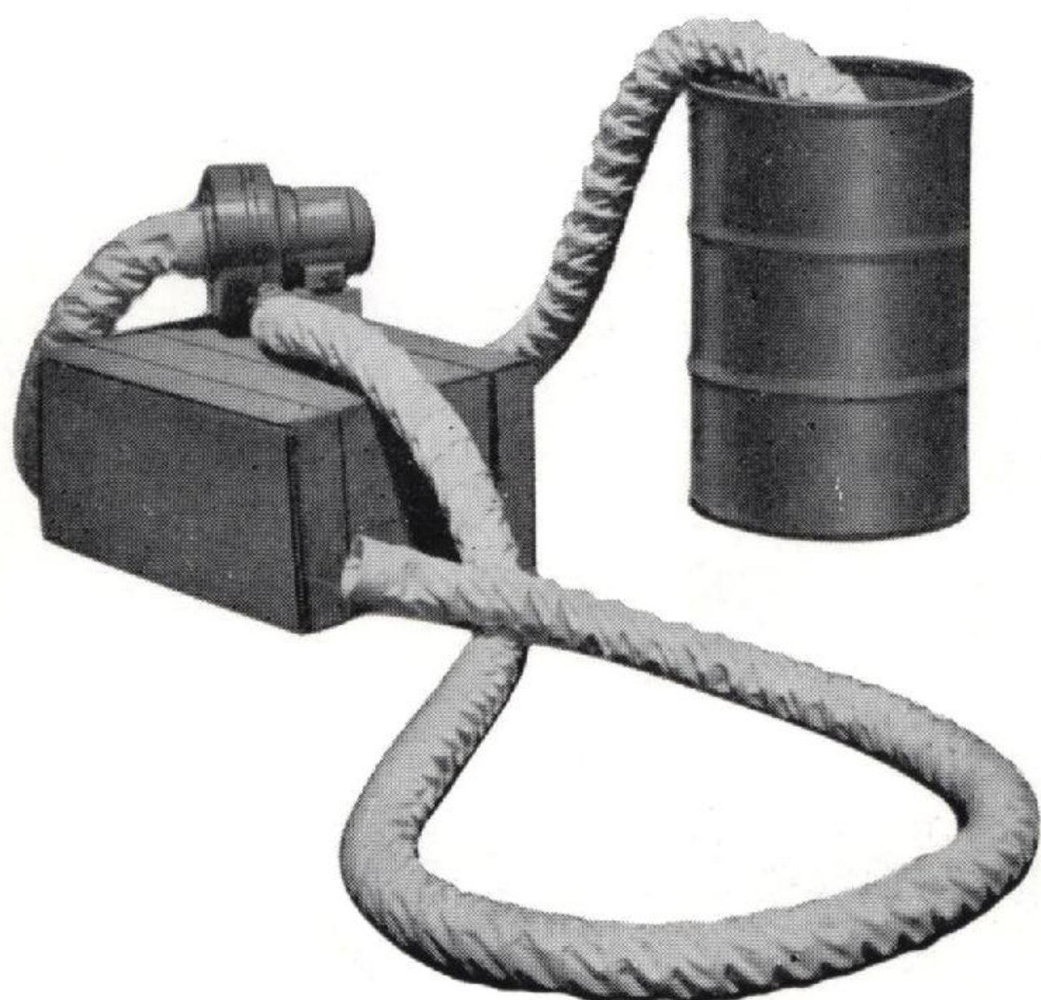
上下共送風機と螺旋式風管の使用中的実況
