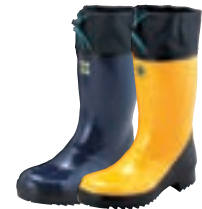
カラー安全ゴム長 ST#991 ●JIS T 8101 CII/L/P合格 ●踏み抜き防止板入り ●つま先を保護する鉄芯内蔵、耐油性底 ●冷気・雨を防ぐ履口カバー付き ●M(24.5~25cm)、L(25.5~26cm)、LL(26.5~27cm)、XL(27.5~28cm)
