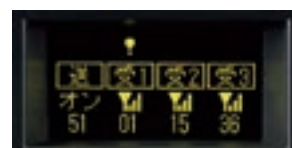
干渉または他社製の無線機が使用しているチャンネルを警告マークで表示
