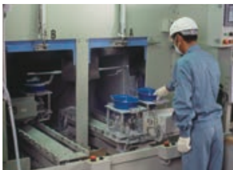
FRP製帽体仕上げ
