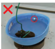
帽体に割れ等がある場合は漏電し、スパークします
