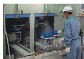
FRP製帽体仕上げ
