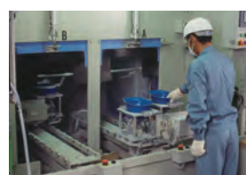
FRP製帽体仕上げ
