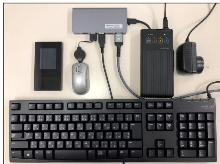
USB Type-CハブにLANケーブルを接続して有線でネットワークに接続する方法等でも操作を進めることができます。
