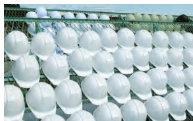
屋外曝露試験
