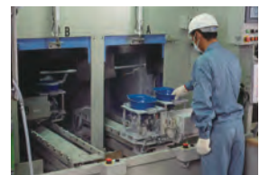
FRP製帽体仕上げ
